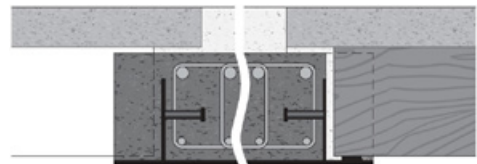
Stropy zespolone drewniano-betonowe (część betonowa prefabrykowana). Żebra drewniane.
