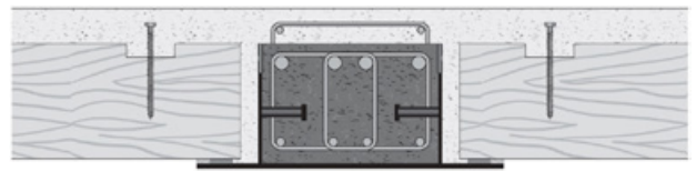
Stropy zespolone drewniano-betonowe (część betonowa wylewana na mokro). Płyty drewniane.
